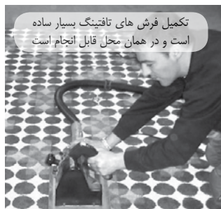
بافنده با استفاده از گان تافتینگ دستی روی نقشه بافت ایجاد می کند.
