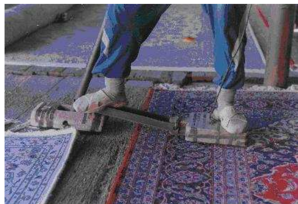
شکل 1 عمل ماشین کشی در روش میخ و تخته ثابت
