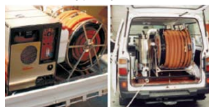
شکل ۸- تجهیزات شستشوی فرش (بخار شویی) نصب شده در پشت ماشین، [۱۹]
