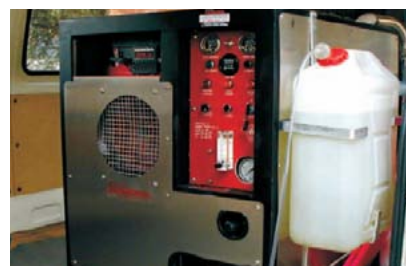
شکل ۷- ماشین بخار شویی [۱۹]
