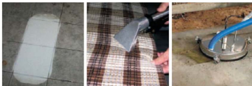
شکل ۶- کاربرد ماشین بخار شویی برای اثاثیه منزل و سطوح سرامیک و سخت [۱۹]
