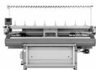
شکل ۱۷ - ماشین بافندگی حلقوی پودی تخت باف شرکت شیما سیک
