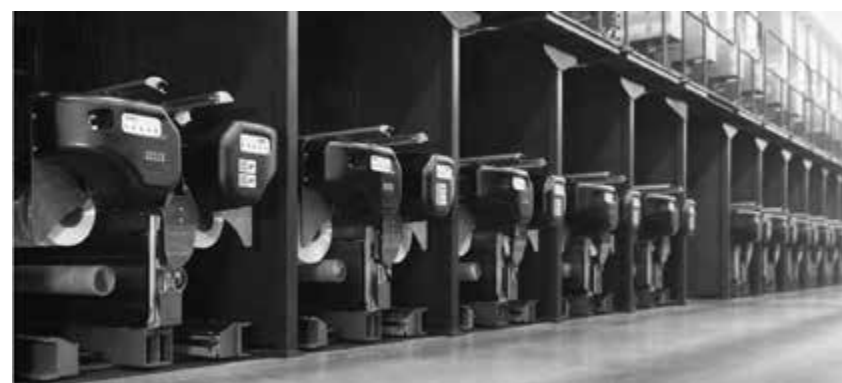
شکل ۱۶ - تصویر ماشین آلات پیچش دوقلو نخ فیلامنتی POY/FDY ساخت TMT
