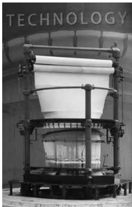
شکل ۱۲ - اولین ماشین گردباف ساخت شرکت تویوتا
