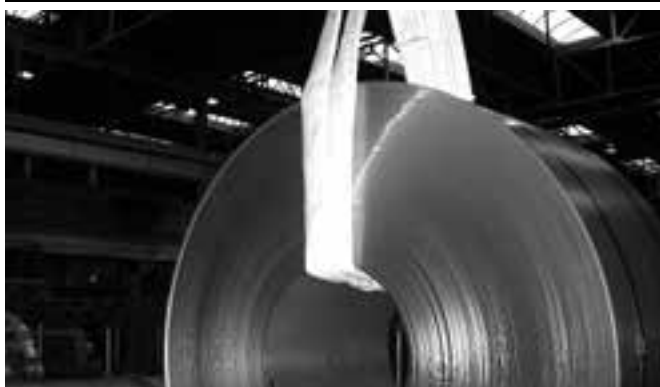
شکل ۱۷ - تسمه های بافته شده از نخ داینیما برای حمل بارهای بسیار سنگین نظیر رول ورق فلزات
