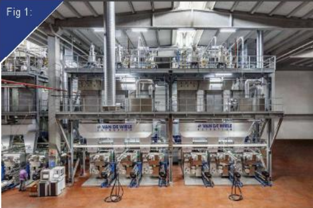
عکس ۱: یک خط تولید چند رنگ نخ فرش BXE در حال کار در کارخانه ای در ترکیه
