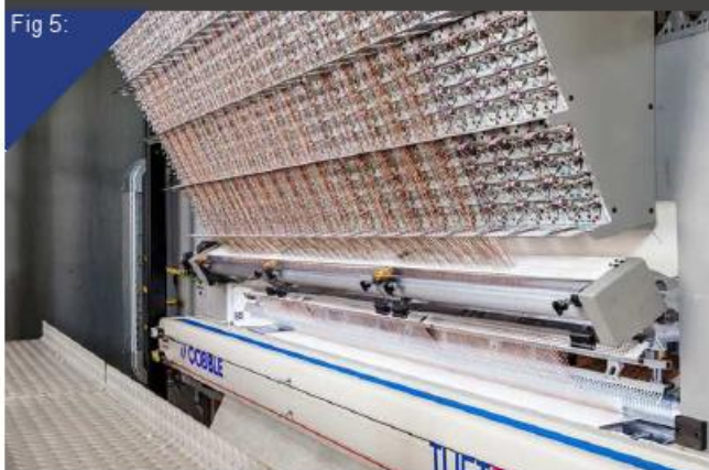
عکس ۵ - ماشین تافتینگ TUFTFX-C برای فرش های خاب پریده و خاب حلقه ای با ارتفاع متفاوت
