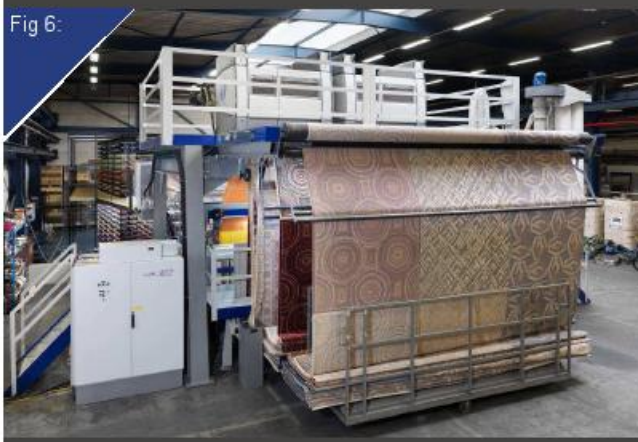
عکس ۶- ماشین بافتندگی فرش RCE02 مجهز به ژاکارد جدید
