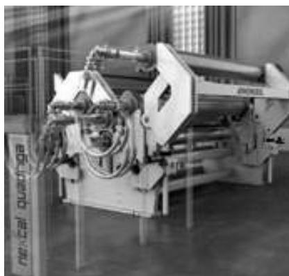
شکل ۴ - آخرین مدل غلطک‌های کالندر شرکت آندریتز کوسترز
