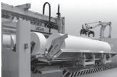
شکل ۹ - دستگاه برش آف-لاین لایه بی بافت اسپان باند آچلی
