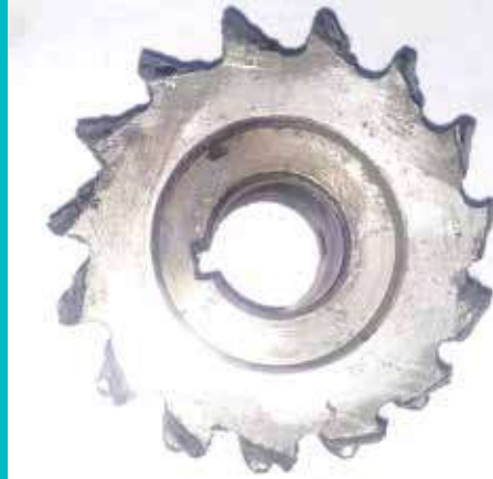
چرخ دنده انتقال حرکت موتور به چرخ دنده حلقه ای سیلندر اصلی کاردینگ Thibeau-خطر یسندگی یاف بلند پلی استر که پس از ساخت مکرر خراب شده است
