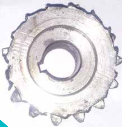
چرخ دنده انتقال حرکت موتور به چرخ دنده حلقه ای سیلندر اصلی کاردینگ Thibeau-خطر یسندگی یاف بلند پلی استر که پس از ساخت مکرر خراب شده است
