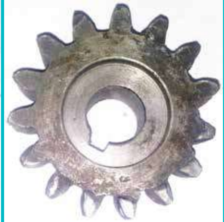
چرخ دنده انتقال حرکت موتور به چرخ دنده حلقه ای سیلندر اصلی کاردینگ Thibeau-خطر یسندگی یاف بلند پلی استر که پس از ساخت مکرر خراب شده است
