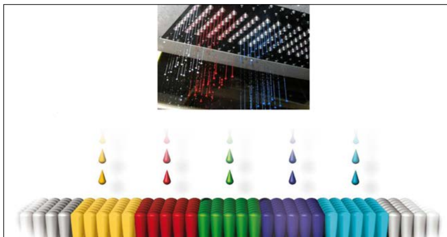
◀ نحوه پاشش رنگ بر روی سطح فرش ماشینی و نفوذ آن تا پشت فرش و آغشته سازی کامل خاب فرش
