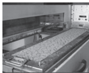
شکل ۲. تجهیزات و شیوه آزمون استاندارد EN ISO 9239-1
