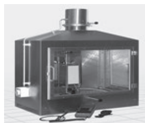
شکل ۱. تجهیزات و شیوه آزمون استاندارد EN ISO 11925-2
