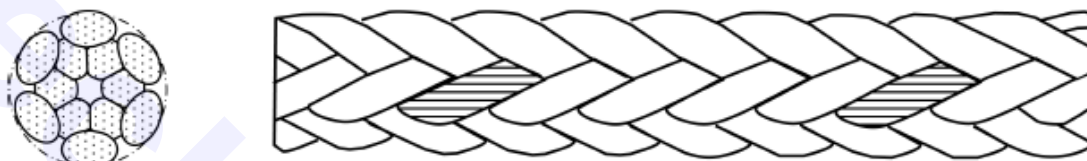
شکل ۲- شمایی از طناب گیس باف ۱۲ رشته ای (نوع T)
