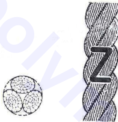
شکل ۱- شمایی از طناب های مهار تابیده ۳ رشته ای (نوع A)
